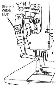
蝶ナットを緩め、上送り量を 大きくする場合は下方へ、 小さくする場合は上方へ 移動し、調整後は蝶ナットを 確実に締める。
