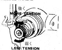
上糸張力の調整は押え金を下げた状態で行って下さい。 Regulate needle thread tension only when presser foot is down.
